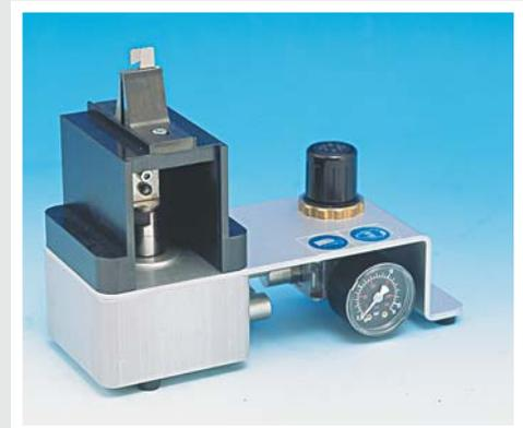
Hector 2 - Macchina pneumatica adatta al taglio di schede pre asolate. La matrice consiste di due parti. Sostituzione delle lame semplice ed economica. Le lame vengono fornite in quattro misure, dimensioni intermedie possono essere prodotte a richiesta del cliente.
