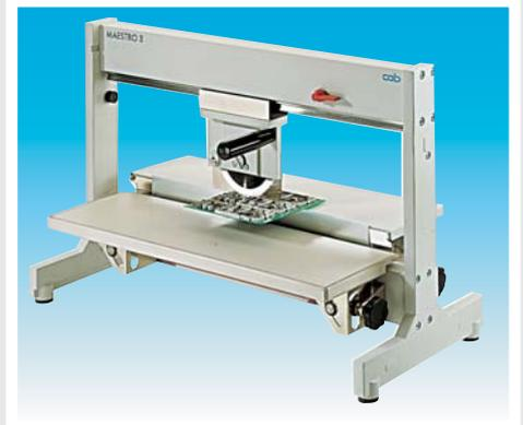
Maestro 3/E - Modello manuale che consente la separazione di grandi quantità di schede elettroniche premontate. La base ed il supporto schede possono essere regolati a qualsiasi posizione richiesta. Non necessita di alimentazione elettrica o aria compressa.
