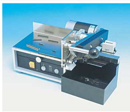
Separatore Strip - Macchina idonea al taglio di connettori strip. Facile regolazione per diverse dimensioni. Perno regolazione per lunghezze da 1 a 32 pins. Fermo a bloccaggio per una corretta posizione. Motore DC con regolazione velocità. Munita di contatore a 5 posizioni per mantenere riferimento del numero di pezzi tagliato.
