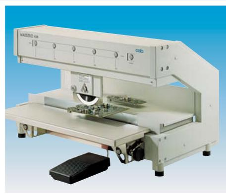
Maestro 4M - Modello motorizzato universale che consente la separazione di schede elettroniche premontate di qualsiasi dimensione. Fornita di lama superiore circolare, lama inferiore lineare e supporto schede.
