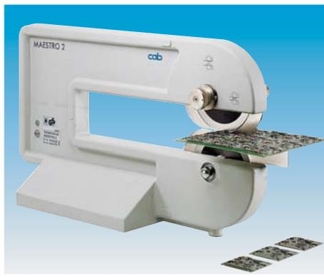
Maestro 2 - Modello manuale che consente la separazione di schede elettroniche premontate in modo preciso ed economico. Non necessita di alimentazione elettrica o aria compressa.
